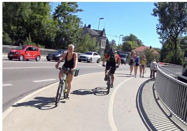
**Bild 18: Seitenraum für Geh-/Radweg im Zweirichtungsverkehr zu schmal (Crescentia Brücke)**
