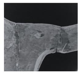
Abb. 10: Um Klarheit über eventuell unter der Fassung verborgene Montagen zu erhalten, wurde der Kruzifixus in der Archäologischen Staatssammlung München geröntgt. Die Röntgenaufnahme zeigt den linken Armansatz mit barockzeitlicher Fügung, gesichert mit einem Eisennagel. (7ß KV; 10 mA)
