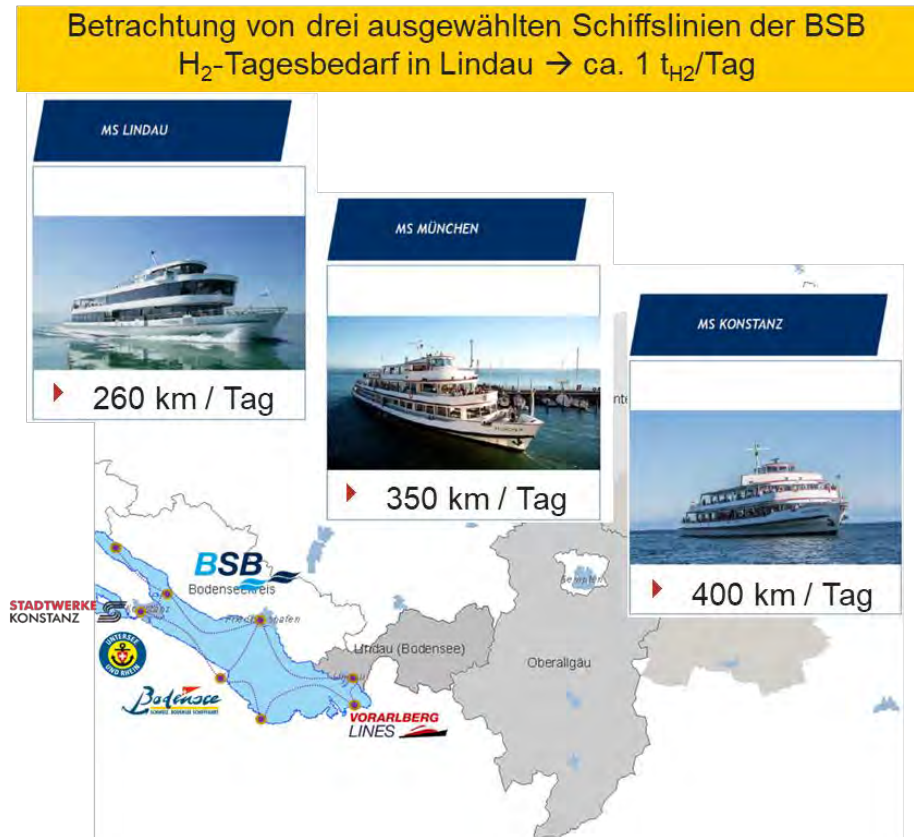
Abbildung 22: Option für die Bodenseeschifffahrt – Umrüstung von drei Schiffen auf H 2 mit H 2 -Bunkerung in Lindau (Fotos: BSB - Bodenseeschiffahrtbetriebe)
