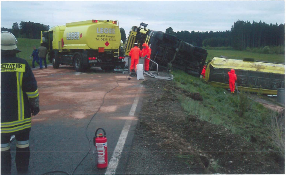
Am 10. Mai 2004 in den frühen Morgenstunden kommt ein Tanklastzug von der B 12 ab und landet in der Böschung. Ab 4.30 Uhr ist die Feuerwehr ca. 10 Stunden im Einsatz. Etwa 5000 Liter Heizöl sind bereits versickert, der restliche Teil wird umgepumpt bzw. mit Bindemittel aufgenommen. Das verunreinigte Erdreich wurde von einer Spezialfirma ausgebaggert und entsorgt.
