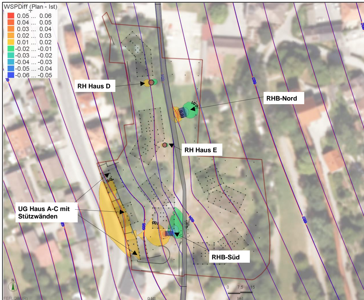
Abbildung 14: Grundwassergleichen für Ist- bzw. Planungszustand (blau bzw. rot), Wasserspiegeldifferenzen in m (Plan - Ist: orange = Aufstau, blau/grün = Absenkung)
