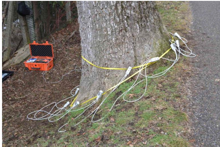
Abbildung 28: Arbotom-Sensoren am Stammfuß des Baumes Esche 2, südliche Seite
