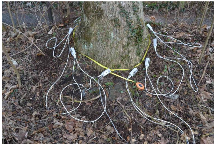
Abbildung 41: Arbotom-Sensoren am Stammfuß des Baumes Esche 5, nördliche Seite
