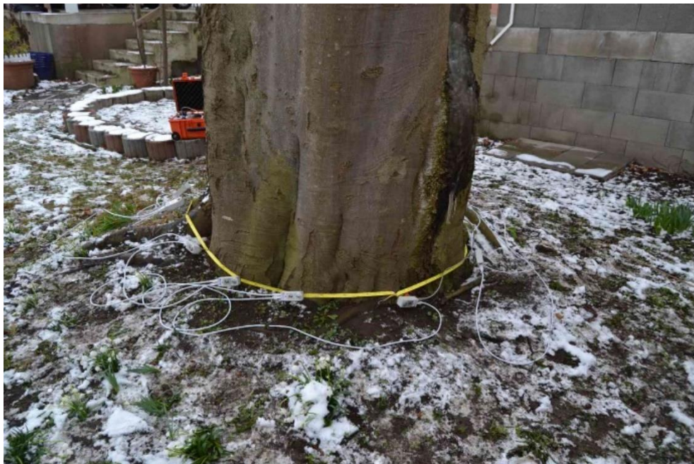
Abbildung 11: Arbotom-Sensoren am Stammfuß des Baumes Rotbuche 1, nordöstliche Seite
