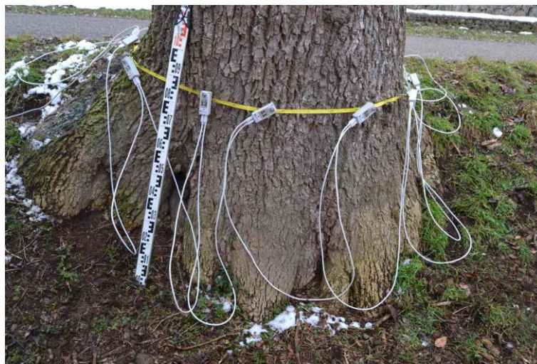
Abbildung 24: Arbotom-Sensoren am Stammfuß des Baumes Esche 2, Östliche Seite
