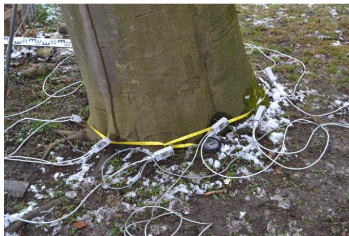
Abbildung 15: Arbotom-Sensoren am Stammfuß des Baumes Rotbuche 2, nördliche Seite
