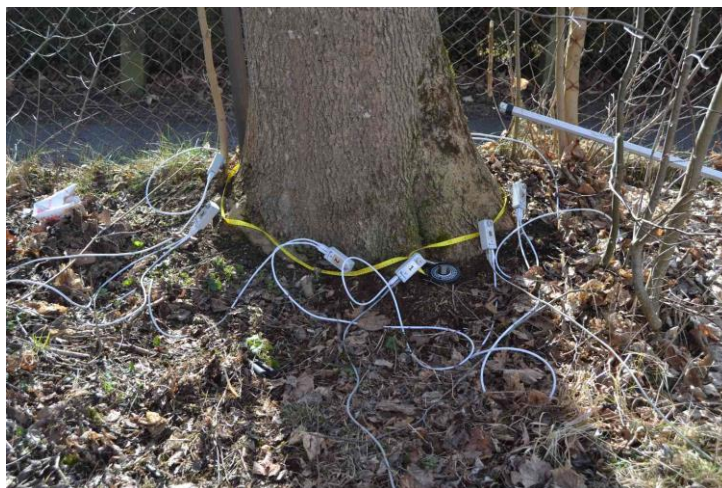
Abbildung 36: Arbotom-Sensoren am Stammfuß des Baumes Esche 4, nördliche Seite
