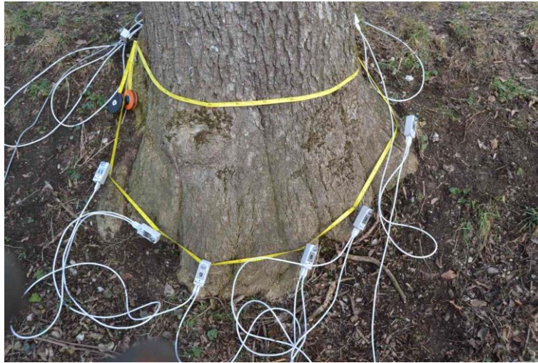
Abbildung 32: Arbotom-Sensoren am Stammfuß des Baumes Esche 3, westliche Seite
