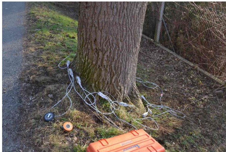
Abbildung 20: Arbotom-Sensoren am Stammfuß des Baumes Esche 1, Nördliche Seite
