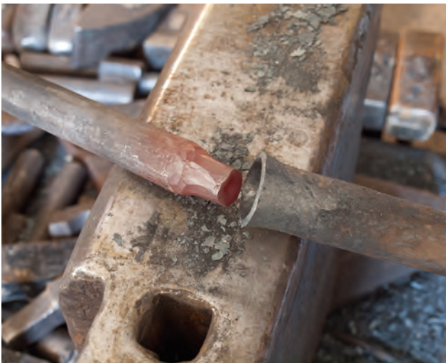
Für die Ringöse wird ein Stück Rundmaterial in ein zuvor verschweißtes Rohr eingesetzt.
