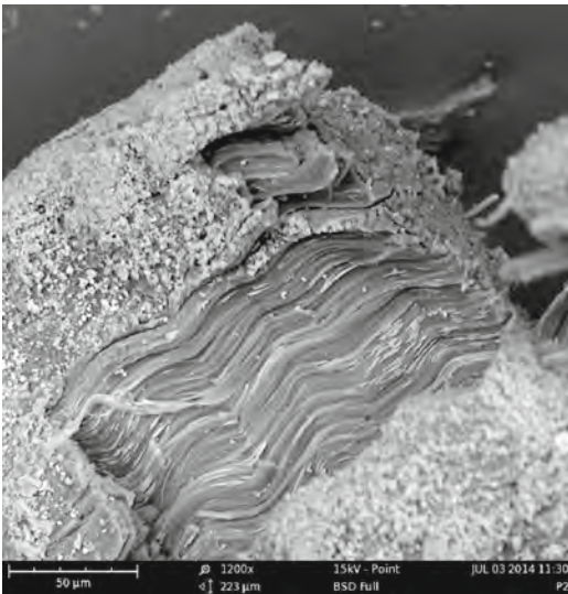
Detail der Faserschnittkante. Die sich im Durchlicht als Querstreifen abzeichnenden Wellen der Fibrillen sind in der räumlichen Darstellung des REM gut zu erkennen.
