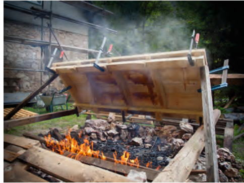
Die schräge Aufstellung der Holztafel bewirkt, dass sich die Hitze gleichmäßig über die Innenseite des Schildes verteilt. Gut erkennbar das ausgetretene Harz auf der Tafelinnenseite.
