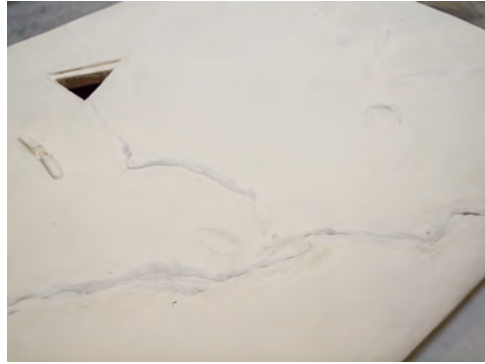
Auch nach insgesamt acht Grundierungsaufträgen bleiben die Konturen der Hautkanten sichtbar.
