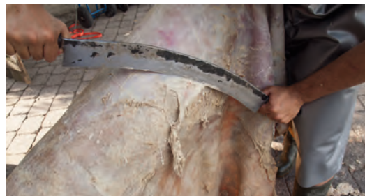
Fleischreste, Bindegewebe und Fett müssen von der Rückseite der Haut vollständig entfernt werden.
