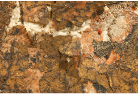
In den Bereichen des abgelösten Firnisses verschwärzte das Zwischgold vollständig. Die rot pigmentierte Anlegesicht tritt unter der partiell verlorenen Vergoldung zutage.
