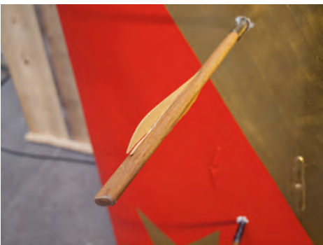
Unten links: Bolzen 1, Treffer im roten Farbfeld. Die rote Farbschicht platzte in größeren Schollen ab, die Grundierung blieb partiell erhalten.
