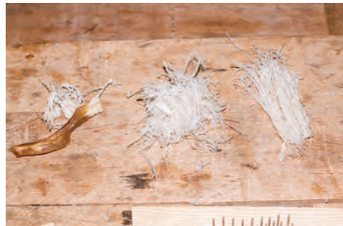
Nach dem Hecheln ergeben sich drei Qualitätsstufen (von links): Ausschuss, der zu Leim verkocht werden kann, kurze Fasern und lange Fasern. Letztere hätte ebenfalls im Armbrustbau Verwendung finden können.
