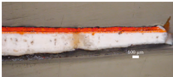
Die sehr dünne Grundierung ist im Querschliff gut als weiße Schicht zu erkennen.
