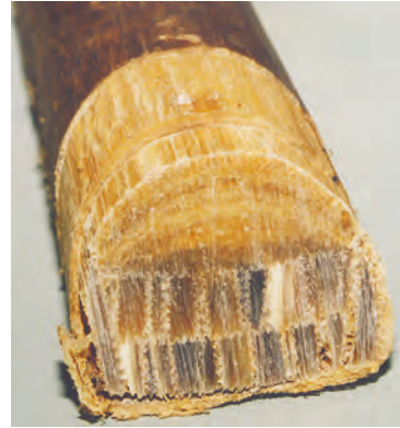
Querschnitt durch einen Komposit-Armbrustbogen. Die unteren beiden Lagen bestehen jeweils aus vertikal stehenden Hornstreifen (1), darüber liegt das Sehnenlaminat (2).
