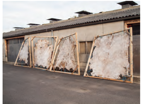
Während des Trocknens spannten sich die Häute so stark, dass sie die Holzrahmen verzogen.
