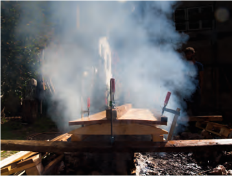
Die mittels Schraubzwingen auf der Form gespannte, noch flache Holztafel zu Beginn des Erhitzens.
