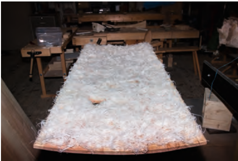
Gleichmäßig verteilte Sehnenlage auf dem Holzkorpus des Setzschildes
