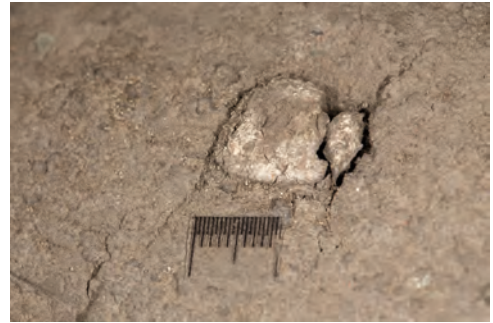
Rhombischer Durchschuss der Hautbespannung bei Treffer 2
