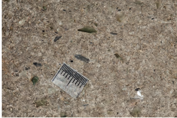
In die Zwischenschicht eingebettete unterschiedlich farbige Glaspartikel.
