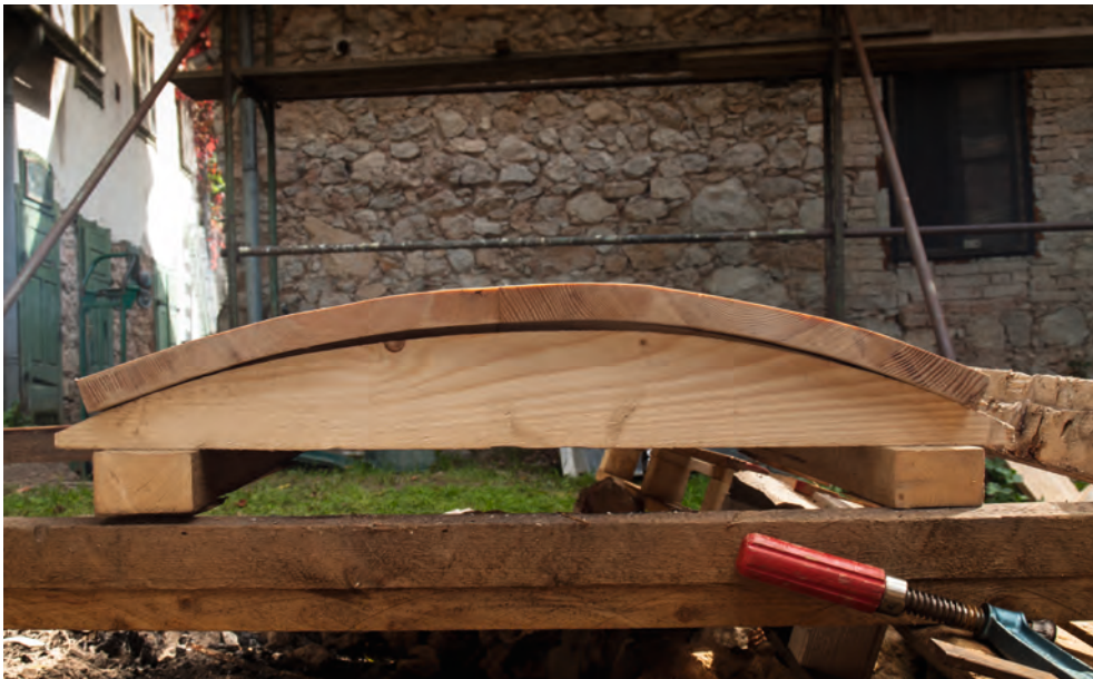
Der Radius der Holztafel erscheint direkt im Anschluss an den Biegevorgang geringer als jener der Form.
