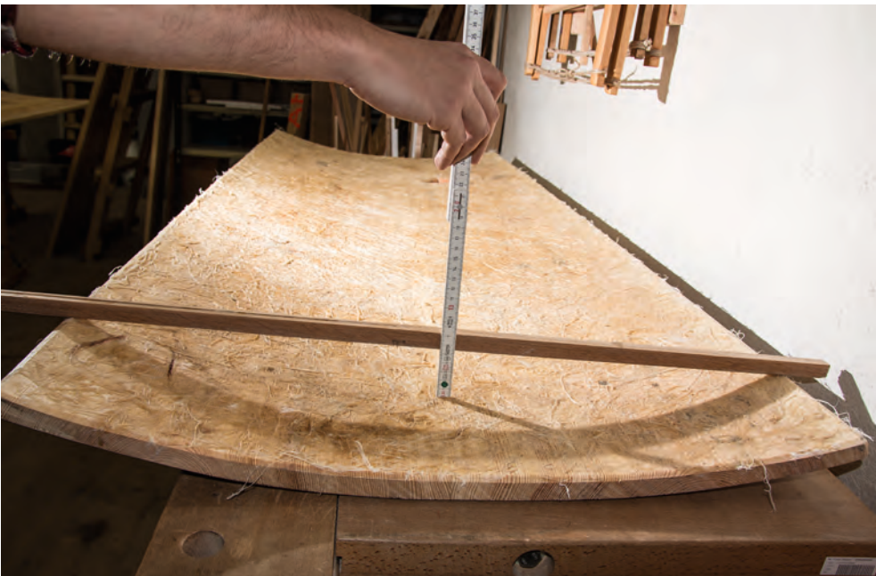
Die Wölbung des Schildes wird durch die Sebnenarmierung dauerhaft fixiert.
