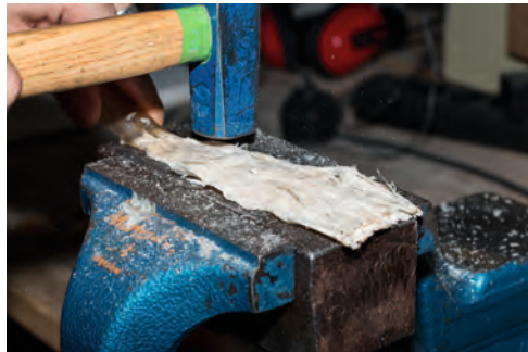
Durch festes Klopfen mit dem Eisenhammer bricht die Sehnen Scheide auf und die einzelnen Fasern beginnen sich zu trennen.
