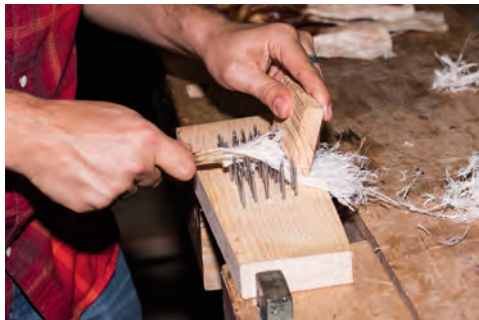
Die Sehne wird über eine Hechel gezogen, wodurch sich die einzelnen Fasern vollständig voneinander lösen.
