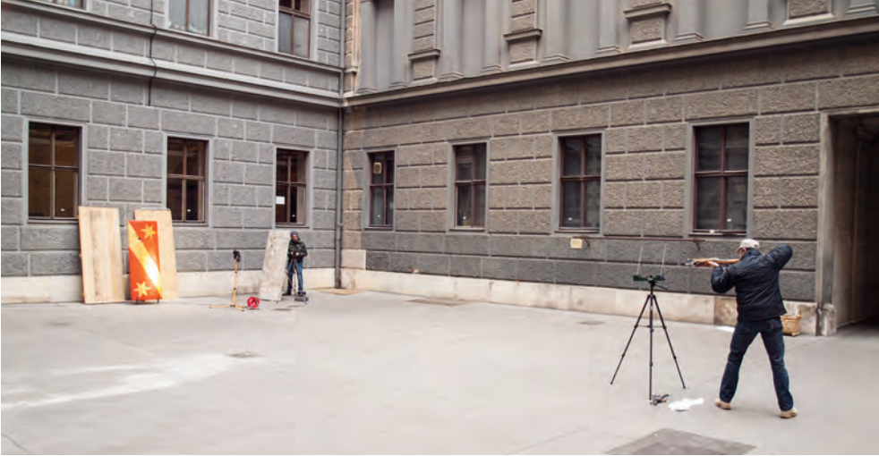
Andreas Bichler führt den ersten Schuss auf die Setzschildreplik aus. Der Bolzen passiert kurz nach Abgabe durch die Armbrust das Geschwindigkeitsmessgerät.
